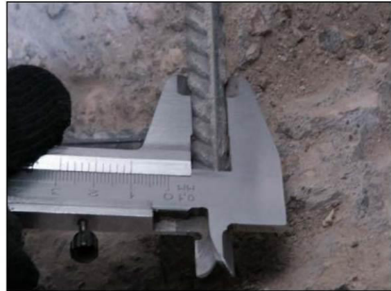
ФОТО 18. Уточнение шага рабочей арматуры напольной поверхности железобетонной плиты перекрытия подвала на пересечении осей «Я/1» и «6/1».
