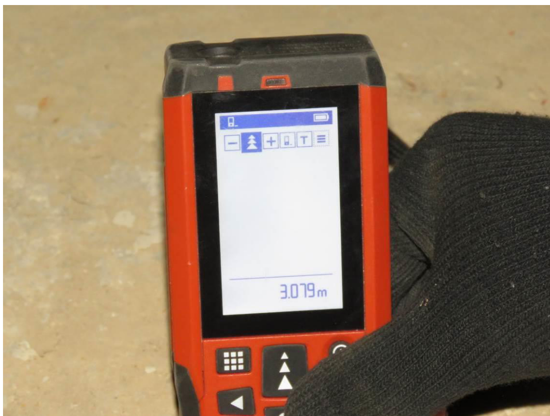
Рис. 2.4. Замер высоты помещений подвального этажа секции №1 при помощи лазерного дальномера HILTI PD-1
